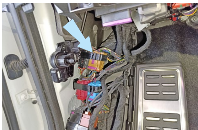
Фото 3.5. Местоположение коричневого разъёма в левой кик-панели
