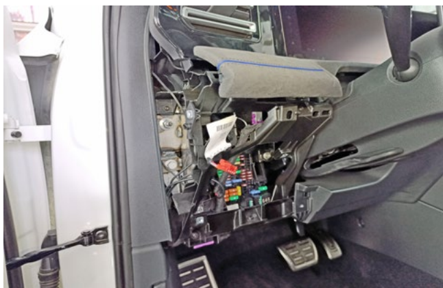
Фото 1.9. Пластиковая накладка под рулевой колонкой снята
