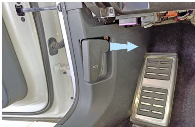
Фото 1.13. Сдвинуть фиксатор ручки отпирания капота в направлении стрелки и снять ручку
