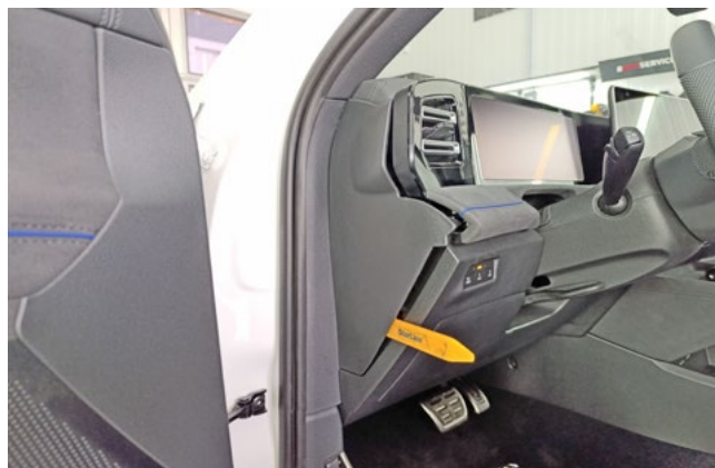
Фото 1.2. Снять левую боковую накладку передней панели
