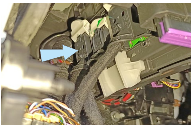
Фото 3.9. Местоположение разъёма «А» блока BCM
