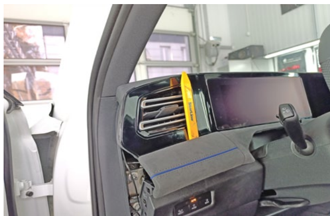
Фото 1.4. Частично снять накладку над рулевой колонкой
