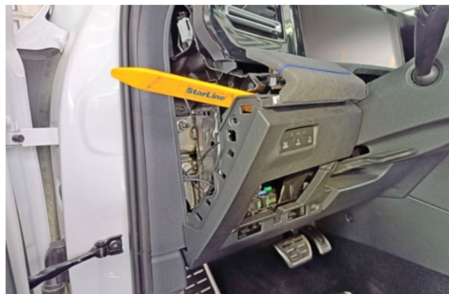
Фото 1.8. Снять пластиковую накладку под рулевой колонкой
