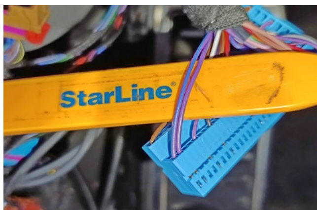
Фото 3.10. Управление кнопкой Старт-Стоп (фиолетово-синий и фиолетовый)
