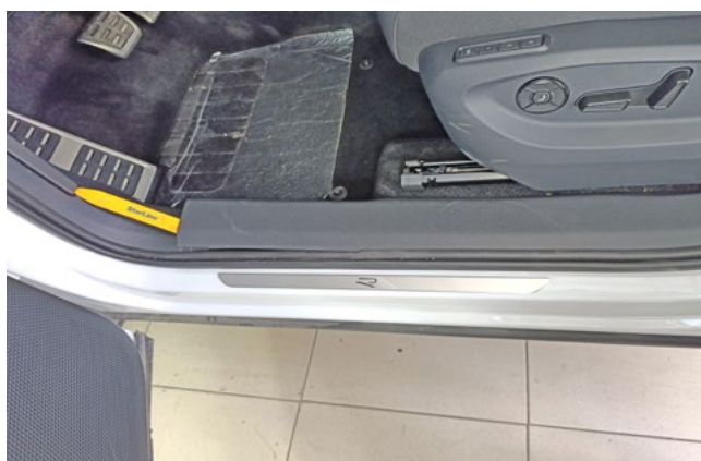
Фото 1.11. Частично снять пластиковую накладку порога двери водителя
