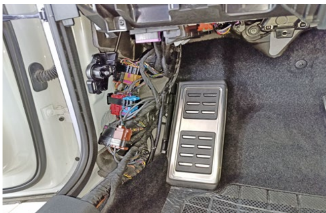
Фото 1.16. Пластиковая накладка левой кик-панели снята
