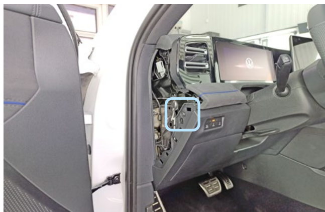
Фото 1.3. Накладка снята. Саморез крепления
