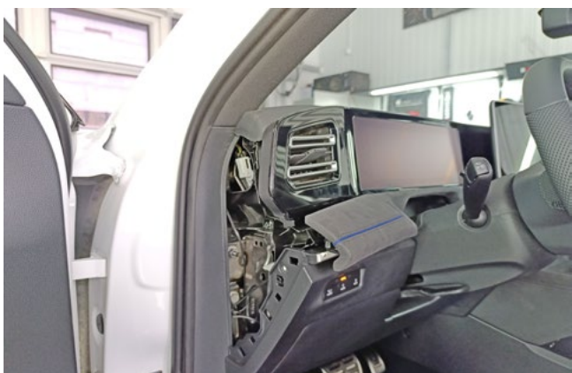
Фото 1.5. Накладка над рулевой колонкой частично снята
