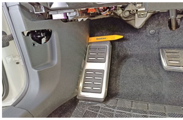
Фото 1.15. Снять пластиковую наладку левой кик-панели
