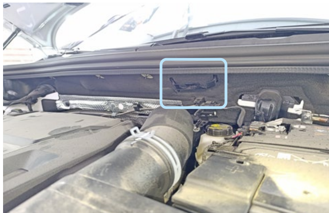
Фото 2.3. Возможное место установки сирены
