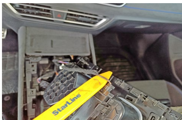
Фото 3.14. Антенна аварийного считывателя (чёрный и коричневый)
