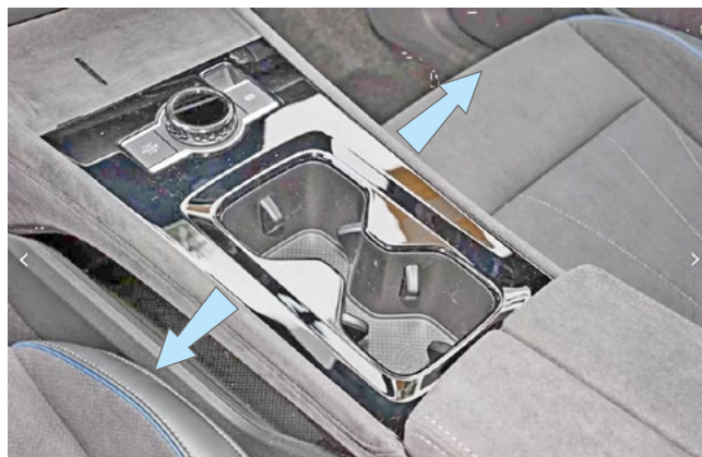
Фото 1.18. Освободить боковые накладки, сдвинув их в направлении стрелок
