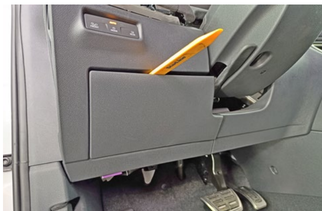
Фото 1.6. Снять крышку монтажного блока предохранителей
