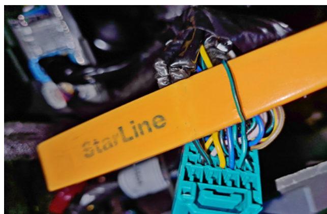
Фото 3.6. Шина данных штатного иммобилайзера (зелёно-чёрный)
