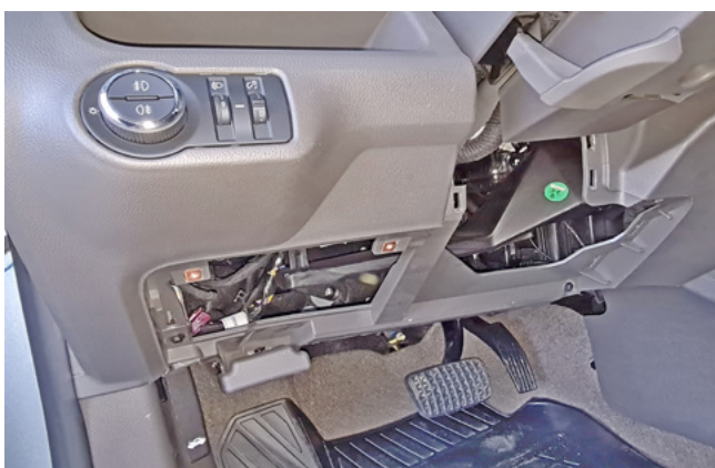
Фото 1.5. Пластиковая накладка снята
