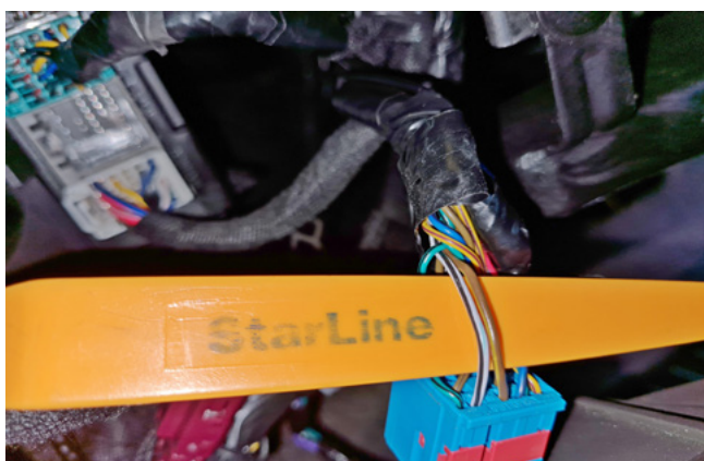
Фото 3.4. Шина CAN-B (коричнево-жёлтый и бело-синий)
