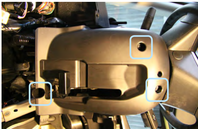
Фото 1.17 Саморезы крепления нижней части кожуха рулевого вала снизу
