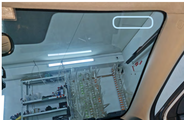
Фото 2.1. Возможное место установки антенного модуля
