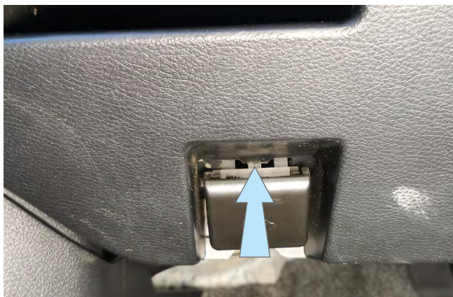
Фото 1.14 Фиксатор крепления ручки капота
