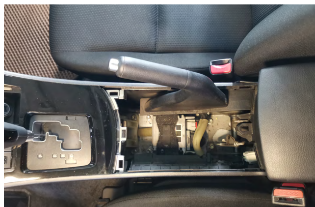
Фото 1.4 Накладка стояночного тормоза снята
