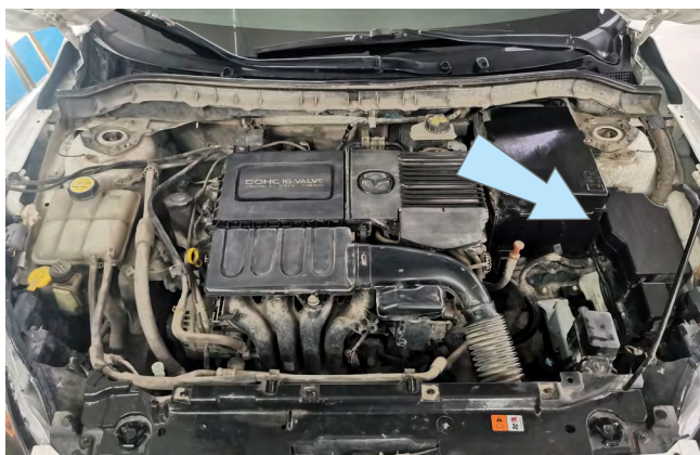
Фото 2.8. Возможное место установки подкапотного блока R6
