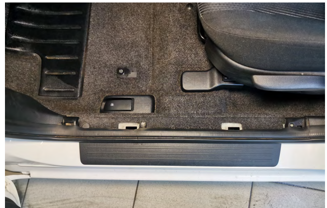
Фото 1.11 Накладка порога двери водителя снята
