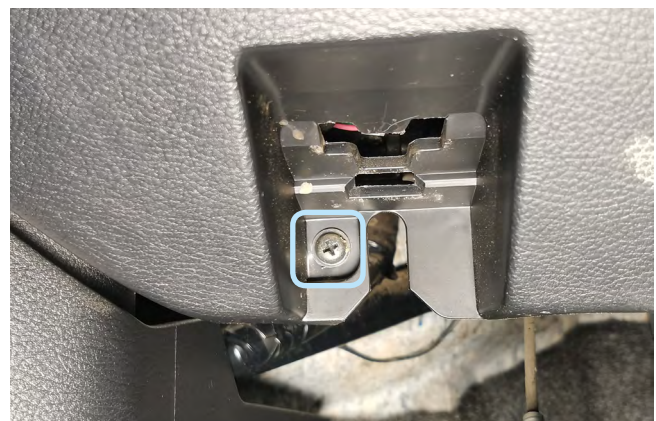
Фото 1.15 Ручка капота снята. Саморез крепления.
