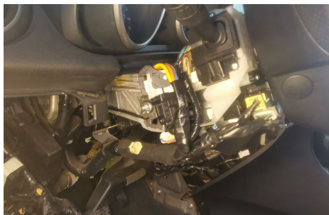
Фото 1.18 Нижняя часть кожуха рулевого вала снята
