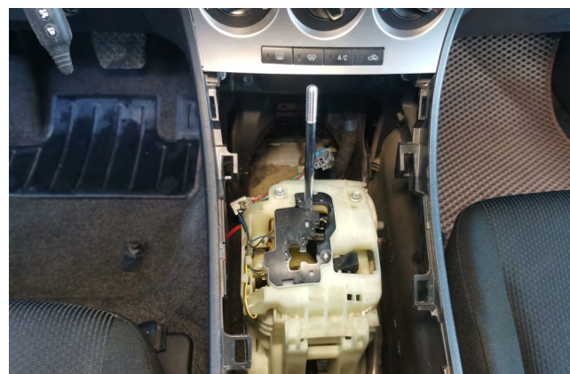
Фото 1.6 Облицовка рычага КПП снята
