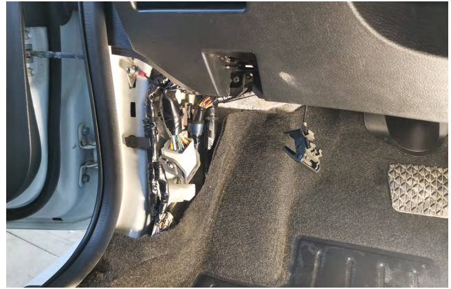
Фото 1.13 Накладка левой кик-панели снята
