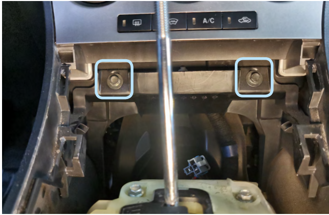
Фото 1.7 Саморезы крепления тоннеля
