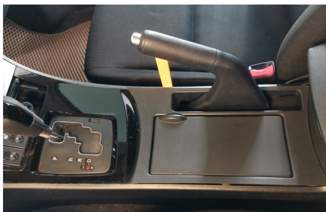
Фото 1.3 Демонтаж накладки стояночного тормоза
