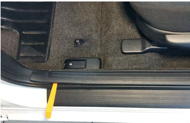
Фото 1.10 Снять накладку порога двери водителя
