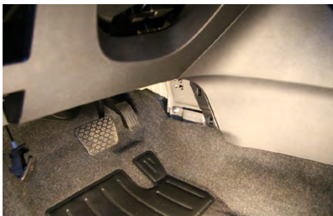
Фото 1.1 Накладка тоннеля с левой стороны
