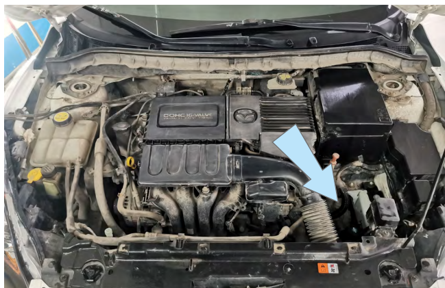
Фото 2.4. Место установки датчика температуры двигателя
