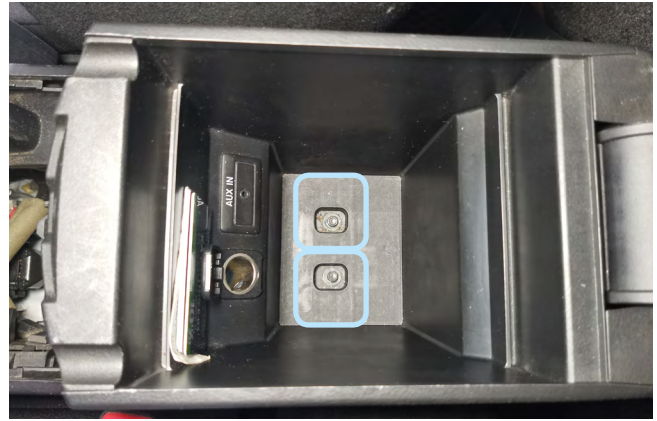
Фото 1.8 Саморезы крепления тоннеля в подлокотнике
