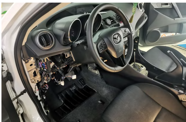
Фото 1.16 Накладка под рулевой колонкой снята
