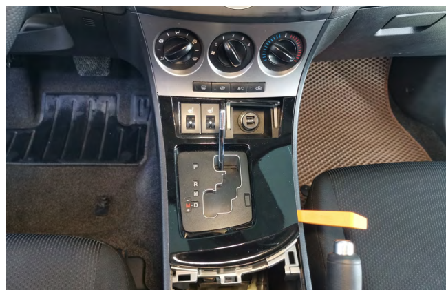
Фото 1.5 Снятие облицовки рычага КПП
