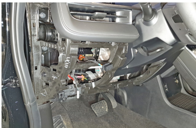
Фото 1.5. Пластиковая накладка под рулевой колонкой снята
