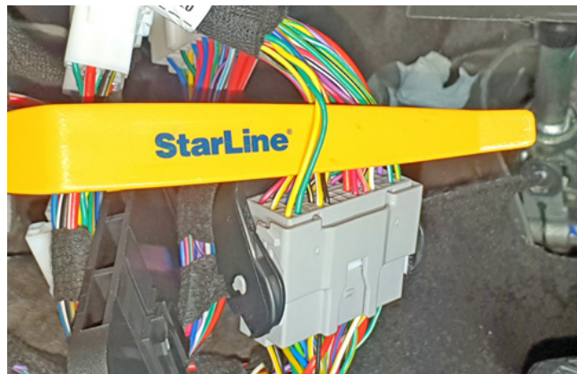
Фото 3.4. Шина CAN-A (жёлтый и зелёный)
