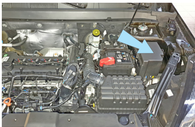
Фото 2.9. Возможное место установки подкапотного блока R6
