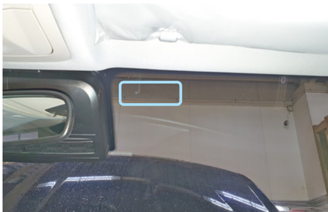
Фото 2.1. Возможное место установки антенны 868 МГц
