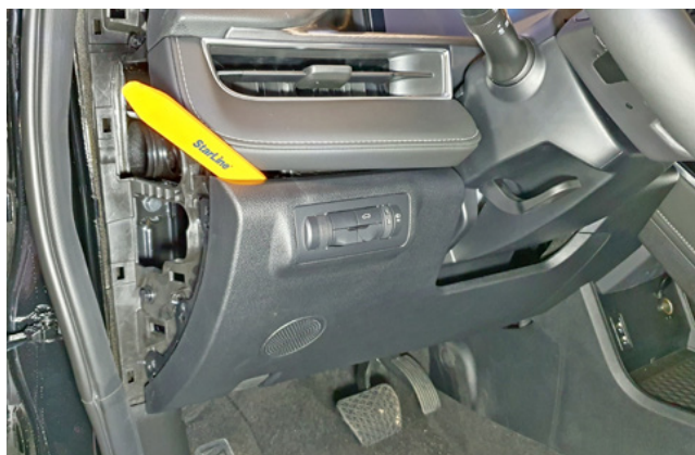
Фото 1.4. Снять пластиковую накладку под рулевой колонкой
