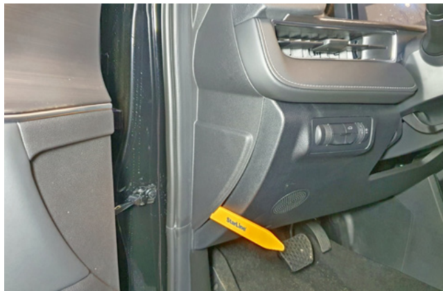
Фото 1.2. Снять боковую накладку передней панели
