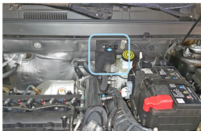
Фото 2.3. Возможное место установки сирены
