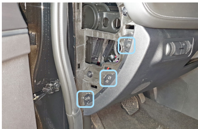
Фото 1.3. Саморезы крепления пластиковойкладки под рулевой колонкой
