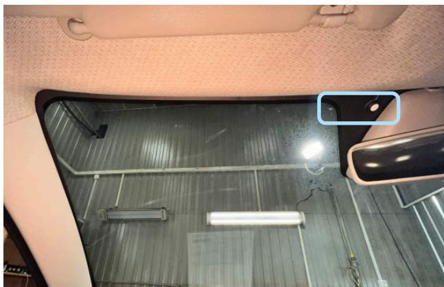
Фото 2.1. Возможное место установки антенны (сервисной кнопки)
