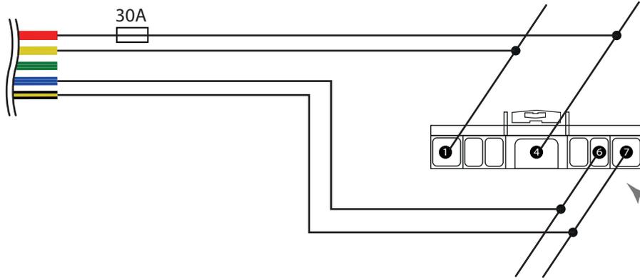
разъём замка зажигания
