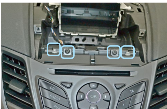
Фото 1.27. Крепление панели управления магнитолой
