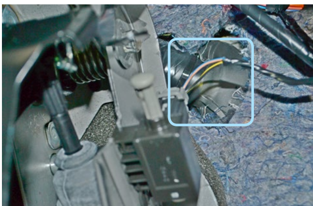
Фото 2.11. Штатный уплотнитель. Вид со стороны салона
