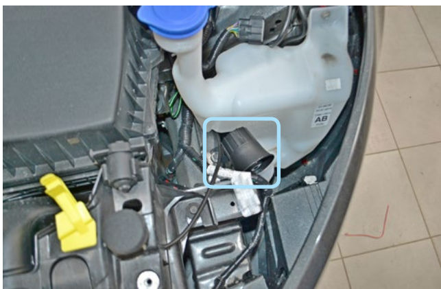
Фото 2.5. Возможное место установки сирены
