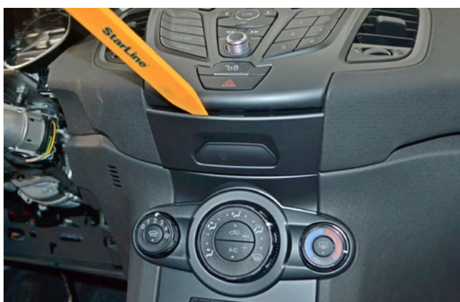
Фото 1.23. Снять накладку центральной консоли
