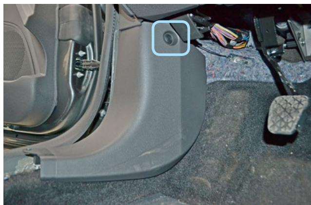
Фото 1.4. Клипса крепления пластиковой накладки левой кик-панели
