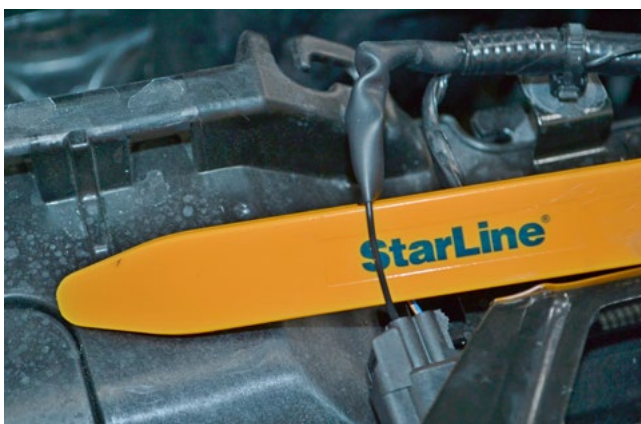
Фото 2.10. Подключение массы концевика капота (чёрный)
