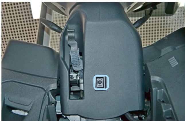
Фото 1.13. Саморез крепления нижней части кожуха рулевого вала
