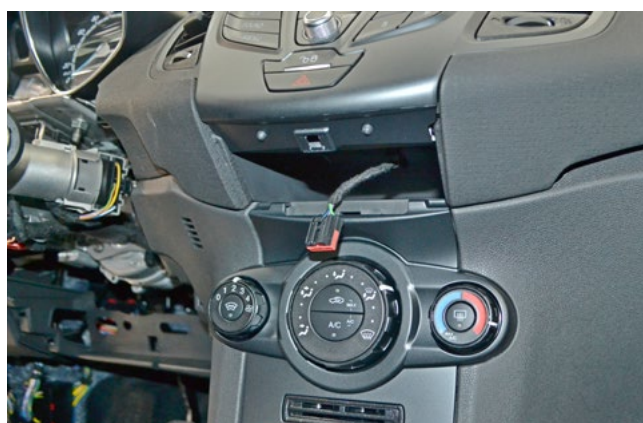
Фото 1.24. Накладка центральной консоли снята
