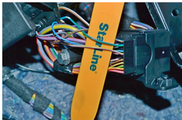
Фото 3.6. Управление световыми сигналами (жёлто-фиолетовый и зелёно-синий)
