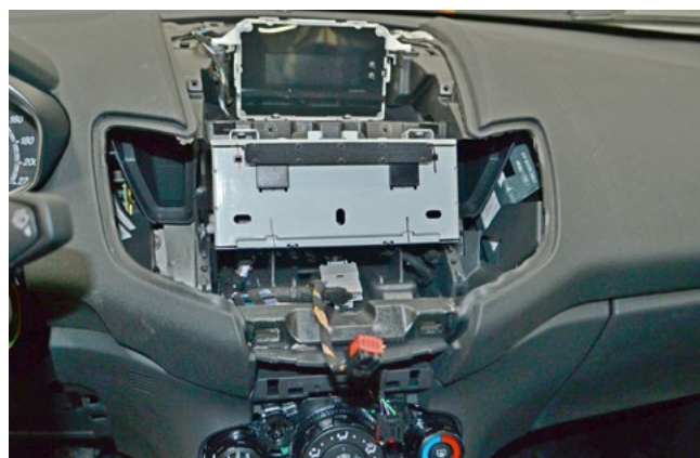
Фото 1.29. Панель управления снята
