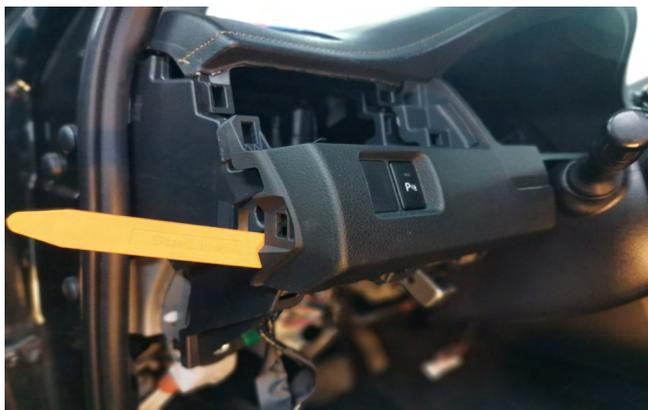
Фото 1.18. Снять накладку панели приборов
