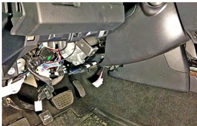
Фото 1.10. Накладка под рулевой колонкой снята
