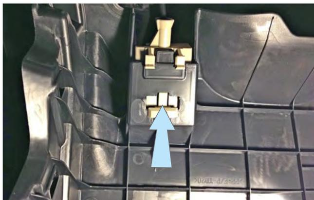
Фото 1.9. Фиксатор ручки открывания капота
