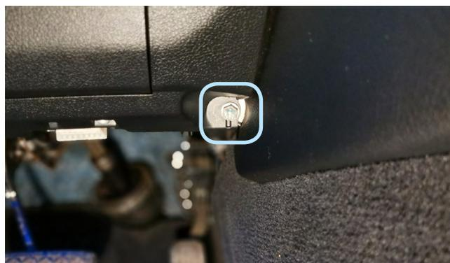
Фото 1.8. Болт крепления накладки под рулевой колонкой
