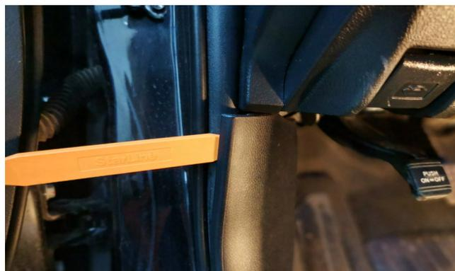
Фото 1.4. Снять наскладку левой кик-панели
