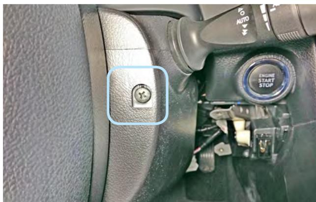
Фото 1.14. Саморез крепления кожуха справа
