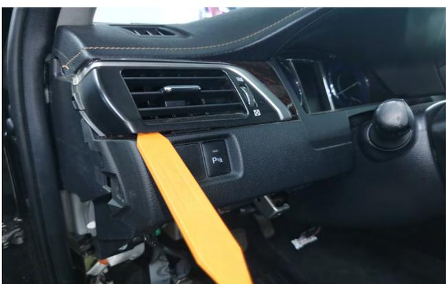
Фото 1.16. Снять левый воздуховод
