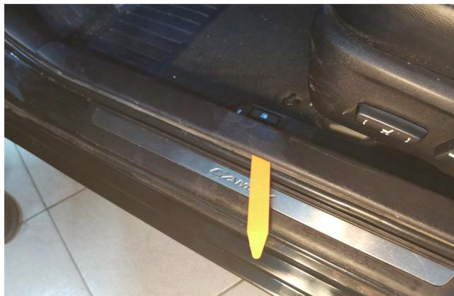
Фото 1.2. Снять накладку порога двери водителя
