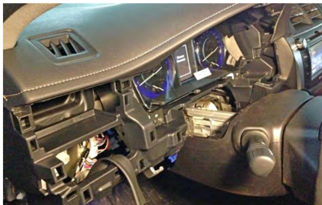
Фото 1.19. Накладка панели приборов снята
