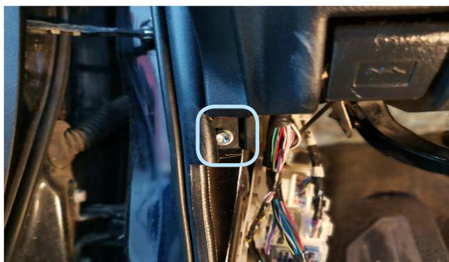
Фото 1.7. Болт крепления накладки под рулевой колонкой
