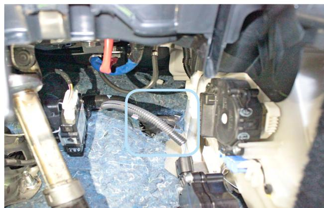
Фото 2.6. Штатный уплотнитель. Вид со стороны салона (капота)
